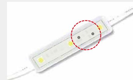
【ビス止め方式】 基板とワイヤーの導通が緩い ビスが取れやすい
