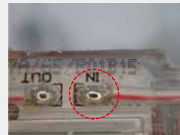
【半田付け方式】 基板とワイヤーの導通が強固
