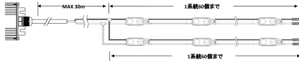
※ 配線を延長する場合、VCTF-1.25sq / AWG16 より太いケーブルを使用して下さい。
