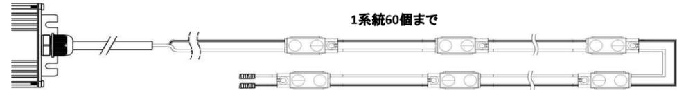
⚠ 電圧降下による輝度低下、輝度ムラを防ぐため、電源-モジュール先頭までは最長30m、さらに配線1系統に繋げるモジュール数は直列最大60個までを目安として下さい。60個以上を繋ぐには、下図のように電源からなるべく近い部位で分岐配線し接続して下さい。
