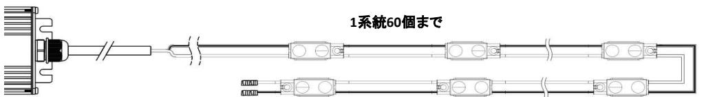
**!** 電圧降下による輝度低下、輝度ムラを防ぐため、電源一モジュール先頭までは最長20m、さらに配線1系統に繋げるモジュール数は直列最大60個までを目安としてください。60個以上を繋ぐには、下図のように電源からなるべく近い部位で分岐配線し接続して下さい。
