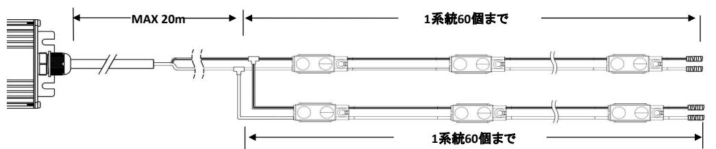
\* 配線を延長する場合、VCTF-1.25sq / AWG16 より太いケーブルを使用してください。
