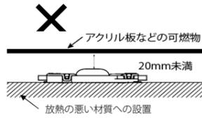
近接照射限度距離(20mm)以内での可燃物への照射、木材など放熱の悪い材質への設置
