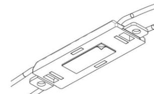
※ 剥離紙を剥がした後の両面テープの粘着面には、手指などで触らないでください。
