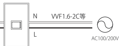
[ON/OFFスイッチ] スイッチ容量を超える場合は スイッチを増設してください。
