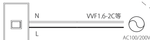
[ON/OFFスイッチ] スイッチ容量を超える場合は スイッチを増設してください。
