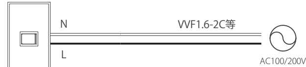
[ON/OFFスイッチ] スイッチ容量を超える場合は スイッチを増設してください。
