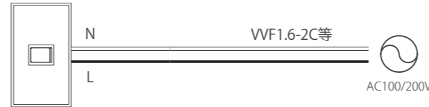
[ON/OFFスイッチ] スイッチ容量を超える場合は スイッチを増設してください。
