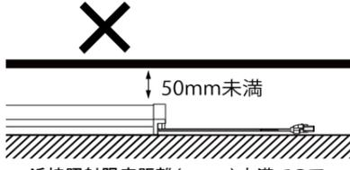
近接照射限度距離(50mm)未満でのアクリル板など可燃物への照射
