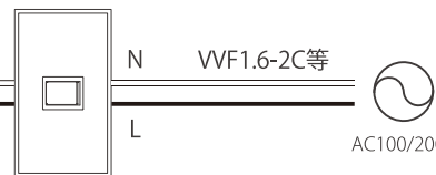
[ON/OFFスイッチ] スイッチ容量を超える場合は スイッチを増設してください。
