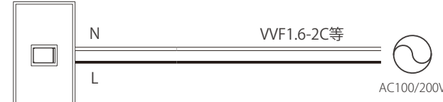
[ON/OFFスイッチ] スイッチ容量を超える場合は スイッチを増設してください。
