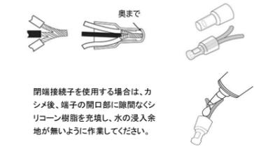
閉端接続子を使用する場合は、カシメ後、端子の開口部に隙間なくシリコン樹脂を充填し、水の浸入余地が無いように作業して下さい。
