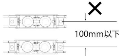
製品間が隣接しており、100mmの製品ピッチ距離が取れない場所
