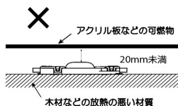
近照射限度距離(20mm)以内での可燃物への照射、放熱の悪い材質への設置
