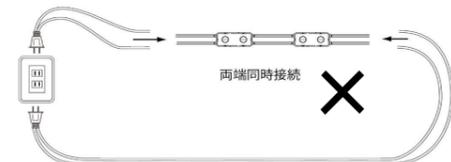
⚠ 結線時には、配線導体露出による漏電、火災、感電事故を防ぐ為、結線部の絶縁処理、防水処理を完全に行ってください。処理を怠った為に起きた、いかなる事故、故障にも弊社はその責を負いません。
