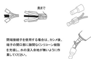
閉端接続子を使用する場合は、カシメ後、端子の開口部に隙間なくシリコン樹脂を充填し、水の浸入余地が無いように作業してください。
