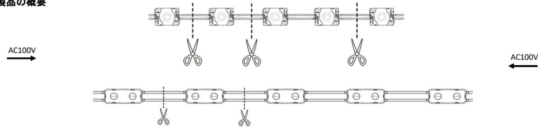
本製品は1個単位で動作します。配線を切断・延長・結線する場合、配線のどの位置でも切り離しても動作します。通電は入出力の極性は無く、配線の左右どちらから入力しても動作します。(但し、両側から同時に入力しないでください。※ [3. 製品の配線切断]の項参照) また、+、-(L、N)の極性もありません。L、Nをどちらに接続しても動作します。
